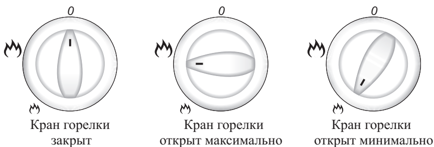
Рисунок 7 - Возможные положения ручек кранов газовых горелок.
